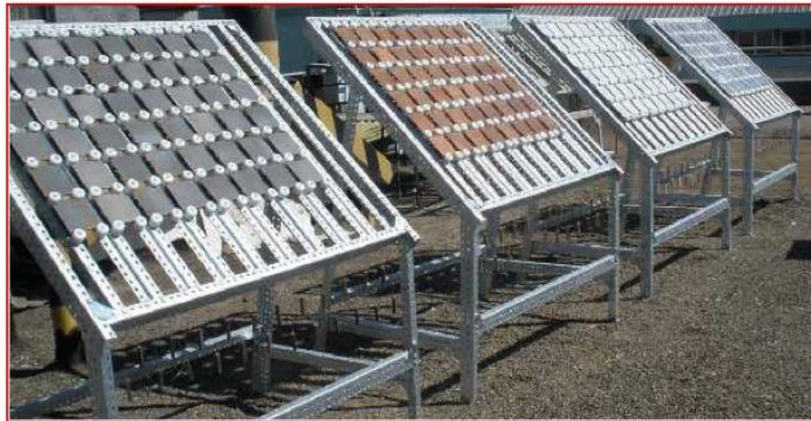
Bastidores con las muestras metálicas (Acero, Acero galvanizado, cobre, aluminio)
