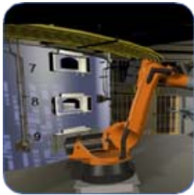
Limpieza Interior Horno de Tostación
